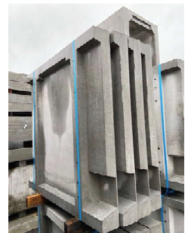
運搬用に固定したパネル
